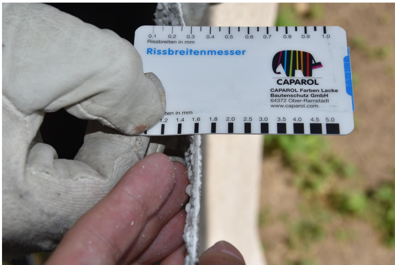
Detail - tloušťka základní výztužové vrstvy a omítky.
